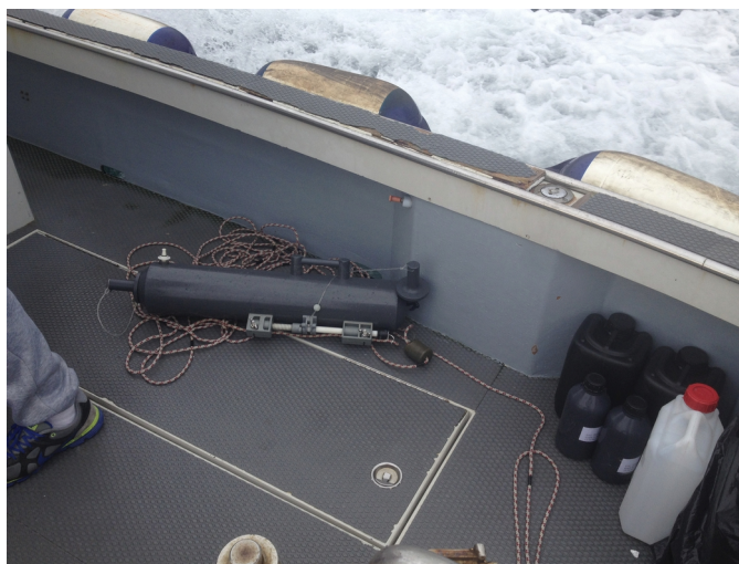
Fig.57 Bottiglia Niskin per il campionamento dell'acqua a differenti profondità
