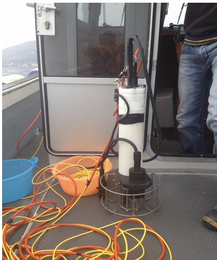
Fig.7 Sonda multiparametrica dotata di sensori per la misura delle principali variabili fisico-chimiche e dei sensori di fluorescenza della clorofilla a e di solido sospeso
