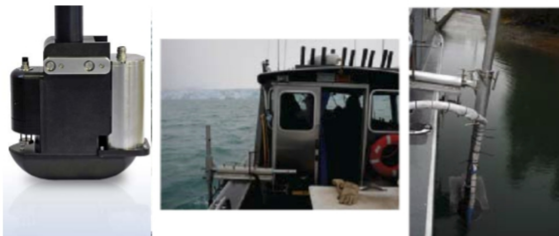
Fig.6 Sistema GeoSwath montato a bordo dell'imbarcazione
